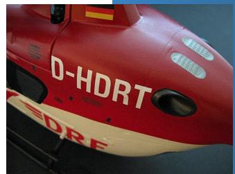
Die Fenster werden demaskiert. Die Stunde der Wahrheit. Hier sieht es ganz gut aus, der Aufwand hält sich in Grenzen. Farbspuren werden einfach abgeschabt, fehlende Farbe wird mit dem Pinsel nachgestrichen (manchmal zum Decken mehrmals).
