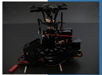
Die Kabel wurden so umverlegt, daß sie seitlich angebracht sind, da sie hinten beim Ein- und Ausbau sonst nur stören.
