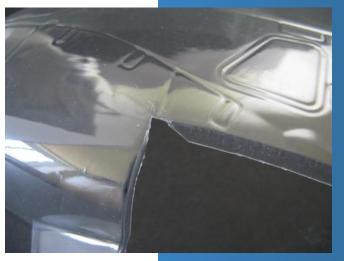
Das Ausgeschnittene wird dann mit einem Winkel aus Folie wieder verschlossen.
