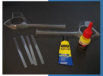
Wenig Sekundenkleber (SK) auf eine Hälfte des Streifens auftragen, breitstreichen und innen (!) an nur eine Rumpfseite ankleben. Längere Stücke vor dem Verkleben mit Tesa fixieren, Kleber in den Zwischenraum laufen lassen und andrücken. Bei den mehr runden Rumpfstücken (z.B. Heckschwanz) dünnere Streifen ankleben. Zweck ist einzig und allein die haltbare Verbindung der beiden Hälften.
