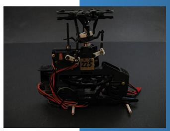
Unten wurden die Röhrchen am Chassis mit Sekundenkleber angeklebt. Ruhig mit reichlich Kleber und Füller befestigen.
