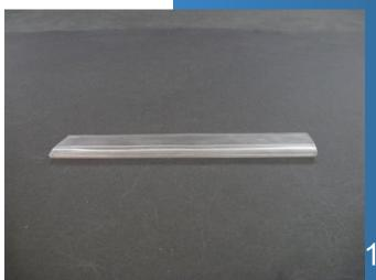
Zum Verkleben der Vorderkante dicken SK innen eintropfen (vorher an den Außenrändern Öffnungen schneiden), innen durch schräg halten verlaufen lassen und zum Austrocknen waagerecht ablegen. Bei der Hinterkante eher dünneren SK nutzen.
