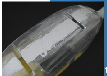
An dieser Stelle ist das Einbauen der Motorgruppe sinnvoll. Später macht man ungewollte Kratzer oder kann schlechter an die notwendigen Stellen ran. Das Loch für die obere Aufhängung wird nochmals geprüft. Die Motorgruppe sollte so hoch eingebaut werden, dass die Taumelscheibe noch verdeckt ist, der Rotorkopf aber auch nicht zu tief sitzt. Die Hauptrotorachse ist etwa mittig des kleinen Seitenfensters.
