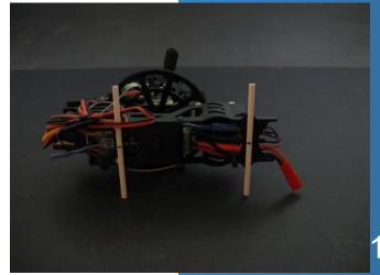
Das Loch für die hintere untere Aufhängung wird angezeichnet, dann ein 2 mm Loch Karbonstange bohren und durch das Aufhängeröhrchen am Chassis schieben.
