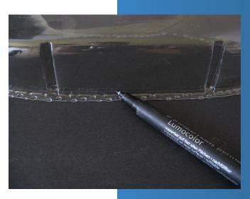
Mit einer gebogenen Fingernagelschere wird jetzt ringsum an der Rumpflinie ausgeschnitten.
