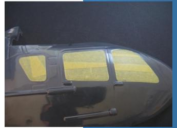
Die Fenster vorn und unten werden einfach mit geeignet breitem Maskierband abgeklebt.
