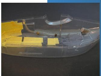
Bei den Heckschwanzteilen werden Einschnitte im Fenestronbereich gemacht. Das nimmt später beim Durchstecken des Impeller-Mantels den Druck raus.
