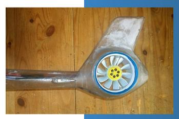
Der obere Teil des Heckschwanzes wird richtig positioniert außen mit Stücken Tesa fixiert. Dann den Heli mit der Unterseite nach oben drehen und in die Rumpfwulst UAP eintropfen lassen.
