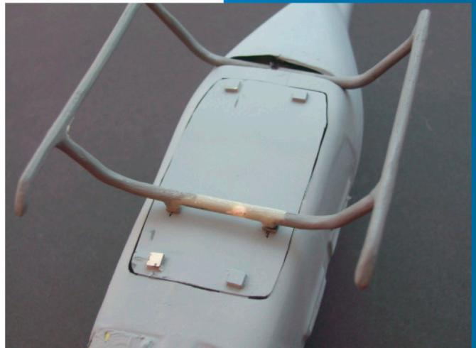
Vorn durch eine Haftmagnet-Lösung. Das Landegestell hat nichts zu halten außer sich selbst. Die verwendeten 5 x 5 mm Magnete und kleine Blechstücke reichen dazu aus.
