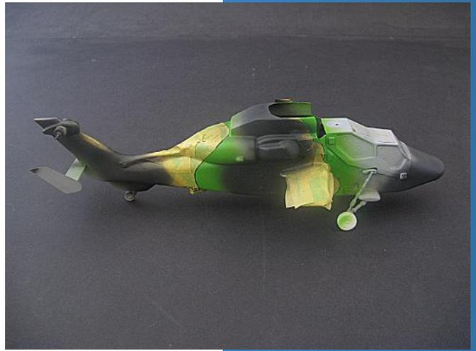
Nach dem Abtrocknen der Farbe auch diese Flächen nach dem Farbplan abkleben. Möglichst großflächig abkleben wegen dem Farbnebel. Als dritter Farbton wird dann der Brauntone gespritzt. Möglichst immer im rechten Winkel und nicht schräg spritzen, da der Farbnebel sich in jeder Lücke ausbreitet.
